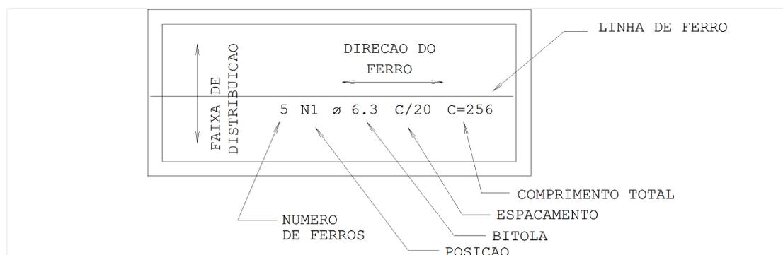
Note a faixa de distribuição de ferros, chamada simplesmente de faixa. Ela se refere à região onde são distribuídas as barras de uma armadura. A quantidade de barras pode ser calculada automaticamente a partir da delimitação da faixa.
