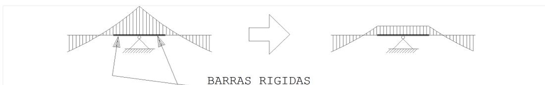
Uma viga pertencente a uma grelha tem seus pontos de apoio em outras vigas com um comportamento de apoio recalçável. A intensidade deste recalque é que definirá se o apoio terá momento negativo ou momento positivo. Conforme conceito adotado no TQS-Vigas, é fundamental que o projetista defina o que é vão e apoio para a viga de
