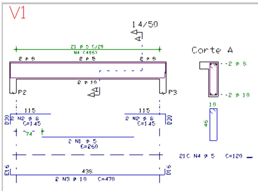
A seção transversal e a vista explodida de estribos são desenhadas em centímetros, na relação de 1:1 entre unidades do mundo real e de desenho. A escala de desenho da elevação longitudinal é a escala principal do desenho, sendo lida e usada por todos os outros editores gráficos, editor de plantas e sistema de plotagem.
