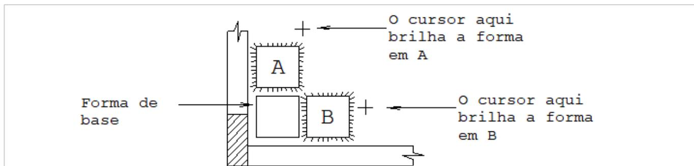
Como as formas são sempre retangulares, existem quatro possíveis posições para inserção de uma cópia de uma determinada forma. Somente as posições onde não há interferência com outras formas ou laje são mostradas. Se
