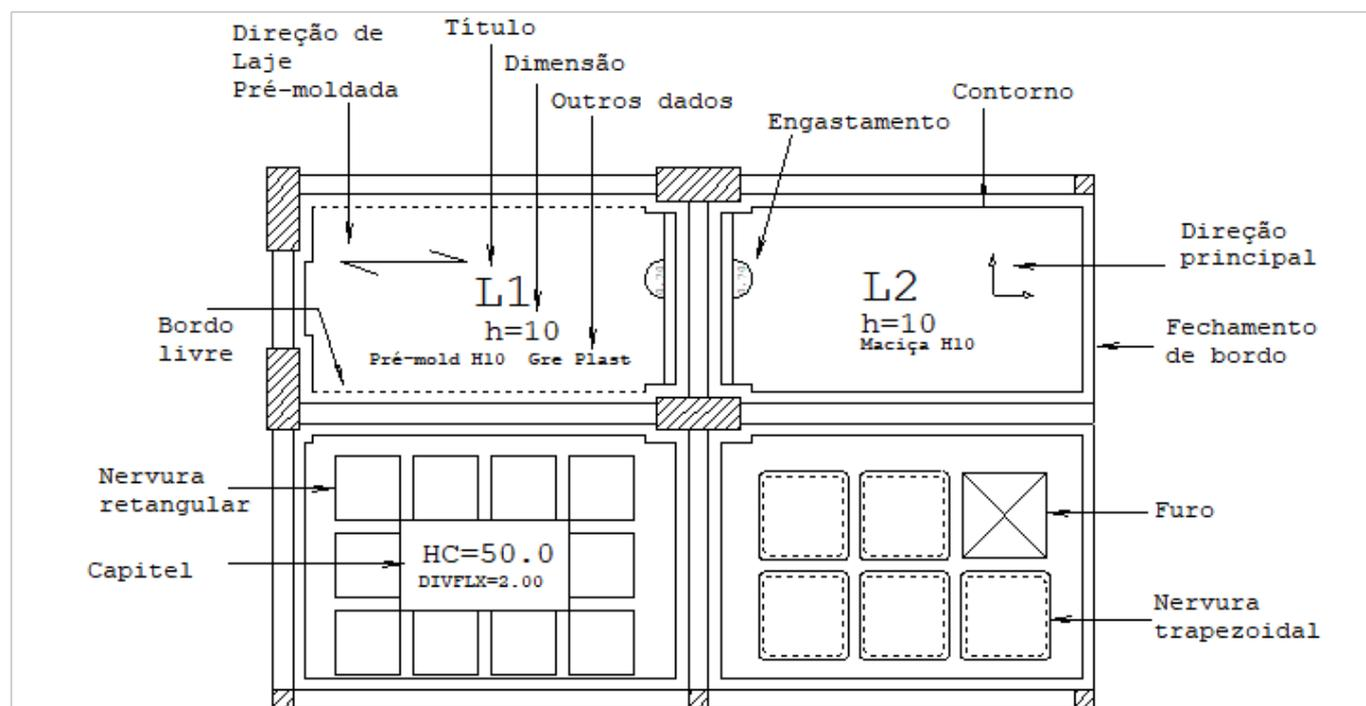
Lajes podem ser alteradas diretamente pelo comando "Alterar lajes", ou alternativamente, através da atribuição de dados atuais.
