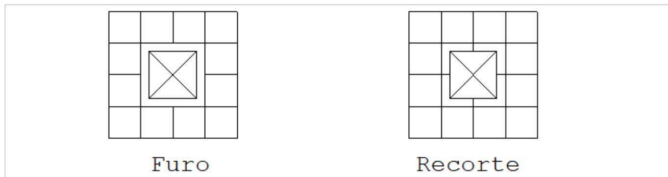
Observe na figura que o recorte deixou quatro barras da grelha em balanço.
