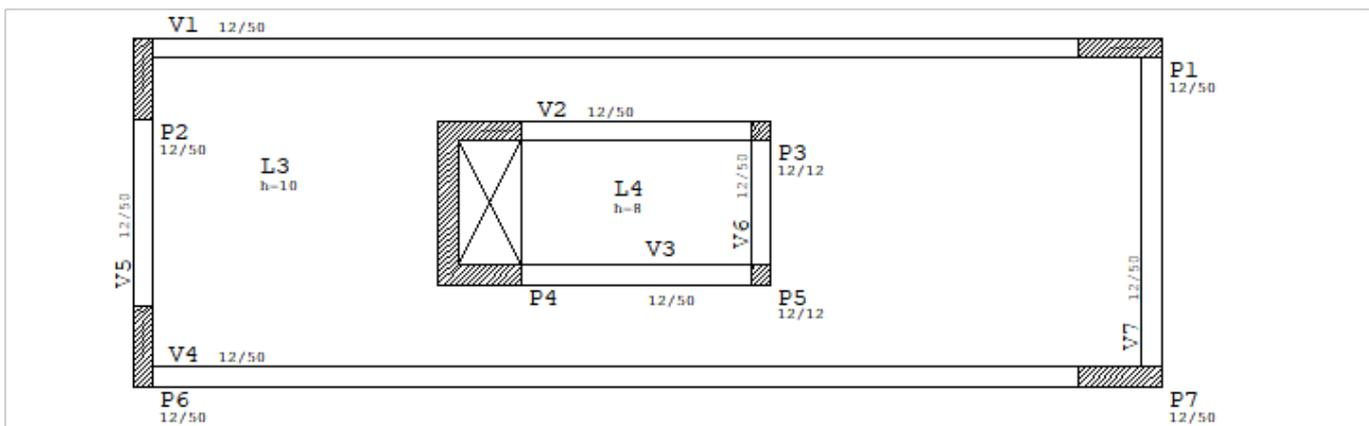
Não é necessário quebrar a L3 em duas para gerar o modelo de grelhas. Para compatibilizar deslocamentos horizontais no pórtico espacial, o Pórtico-TQS determina todos os circuitos de vigas e pilares na planta de formas e faz uma ligação articulada entre os circuitos independentes.
