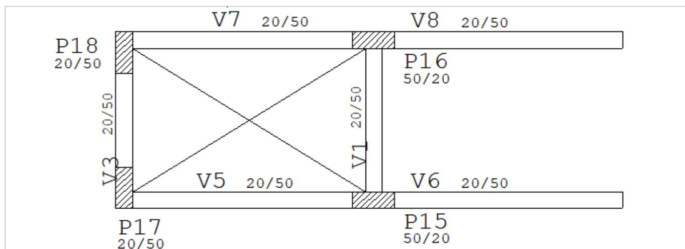
Do lado esquerdo temos um contorno fechado formado pelas vigas V1, V3, V5 e V7 e os pilares P15 a P18. O Modelador mostra este contorno com um "X", indicando uma possível posição para colocação de lajes. Do lado direito, o contorno formado pelas vigas V1, V6 e V8 é aberto, o Modelador não conseguirá reconhecer uma posição para lajes neste ponto.
