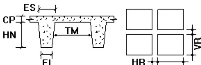
Como outras tabelas do sistema, podem ser definidas por planta, edifício ou globalmente. A tela de preenchimento desta tabela é semelhante à janela de dados de lajes, a única diferença é que agrupa as lajes nervuradas retangulares e trapezoidais:
