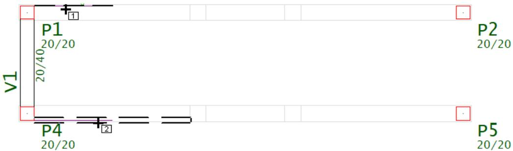
5. Clique no contorno auxiliar inclinado que será o limite lateral do lance de degraus
