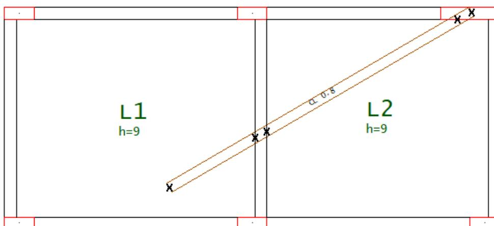
Veja o exemplo acima. Uma carga linear de 0.8 tf/m foi lançada entre duas extremidades, o Modelador calculou cinco pontos notáveis, numerados de PT1 a PT5. As cargas serão lançadas da seguinte maneira:
