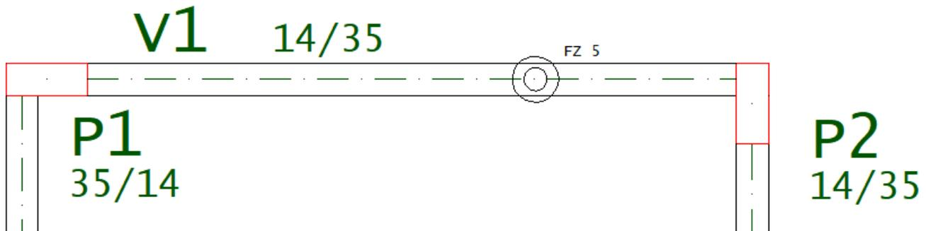
Uma carga concentrada será considerada sobre uma viga se estiver entre as faces das vigas. Qualquer que seja sua posição, será projetada no eixo da viga.
