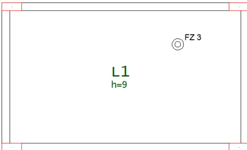
A posição real da carga da laje considerada no cálculo varia com o método. Na distribuição de cargas por processo simplificado, existem dois critérios diferentes que afetam as vigas que receberão a carga. No modelo de grelha, a carga será projetada na barra mais próxima.
