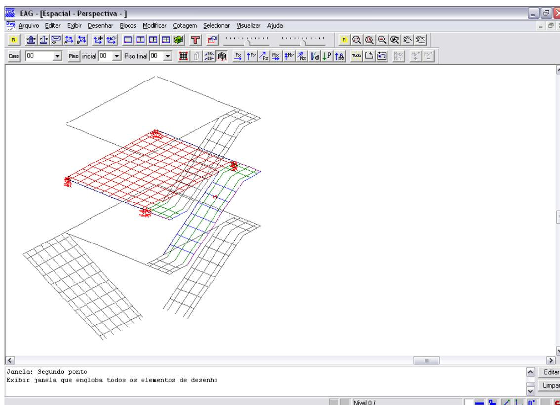
É possível optar pela representação dos pavimentos por grelhas simples, onde apenas os elementos do pavimento são discretizados e a influência dos pavimentos superior e inferior não é rigorosamente considerada, sendo utilizadas condições de contorno aproximadas para a representação dos demais pavimentos. Esse modelo é mais simples, gerando um processamento mais rápido, mas é menos preciso, o que pode levar a esforços não adequados em algumas ligações.
