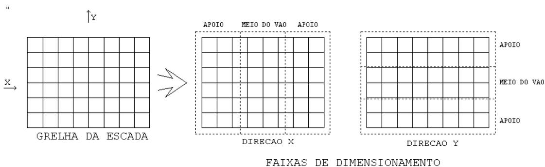
Para cada região, são obtidos valores de momentos máximos e mínimos e normais máximas e mínimas. Nos pontos de momento máximo, a normal é concomitante, assim como nos pontos de normal máxima, os momentos são concomitantes. A princípio, é feita uma envoltória de armaduras resultante do dimensionamento de cada uma das regiões para os esforços máximos obtidos, e os resultados compatibilizados entre as regiões, conforme o detalhamento da escada.
