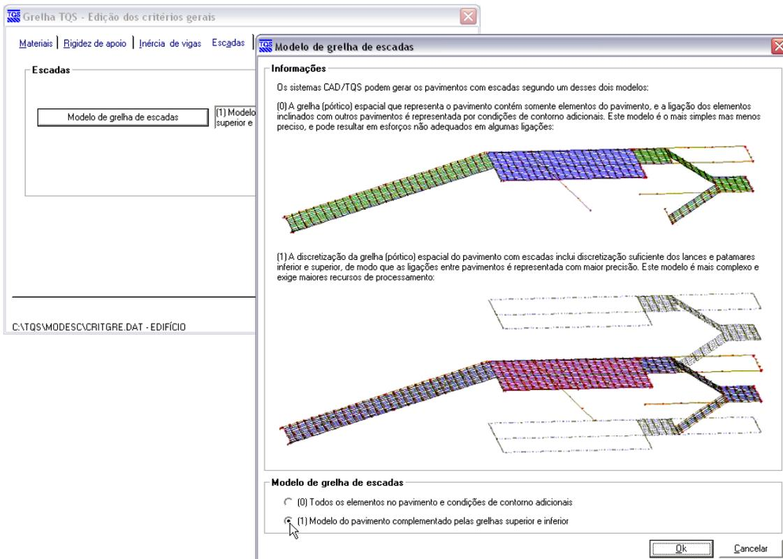
Esse modelo só funciona para um pavimento se os pavimentos inferior e superior tiverem lajes discretizadas. Atualmente, se um deles (superior ou inferior) for grelha somente de vigas, o modelo do pavimento será considerado sem a presença dos pavimentos adicionais.
