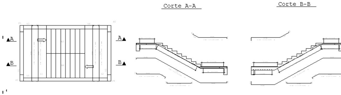
Em geral a armadura dos patamares na direção do lance de escada está detalhada na própria escada. Apenas a armadura transversal é detalhada nos patamares. Em certos arranjos de escada (como um patamar comum a mais de um lance) é possível que o detalhamento não seja totalmente automático. Nestes casos é necessário que o engenheiro complete o detalhamento inserindo ou removendo armaduras do desenho.
