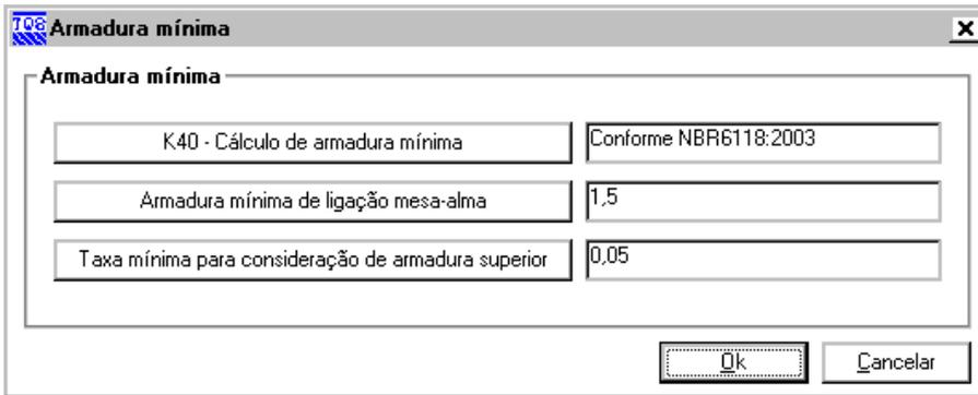
A armadura mínima de ligação mesa-alma, definida em  $\text{cm}^2/\text{m}$ , será usada na verificação dos apoios. Nos locais onde não é obrigatória a presença de armadura superior, qualquer valor calculado abaixo da taxa mínima definida acima será ignorado.
