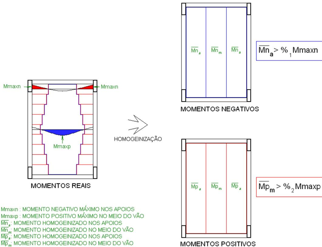
A discretização das escadas em grelhas espaciais leva à concentração de esforços em alguns pontos. Dimensionar todo o modelo pelos piores esforços nestes pontos pode levar a um detalhamento com armadura excessiva. O engenheiro deve avaliar se a hipótese de redistribuição de esforços por homogeneização é aceitável caso a caso. A metodologia adotada é:
