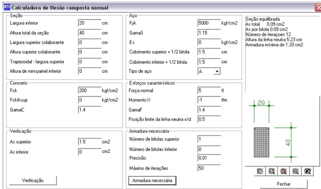
Trata-se de uma calculadora interativa que tem dois comandos: o de verificação de armaduras, e o de determinação de armadura necessária.
