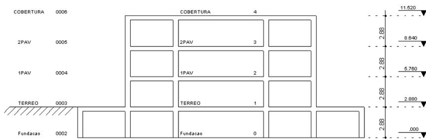
Note que o edifício possui um pavimento Sub-Solo, um Térreo, um 1º Pavimento, um 2º Pavimento e uma Cobertura. A forma da Cobertura é idêntica a do Tipo, porém sem os sem patamares de escada. No caso do 2º Pavimento só há patamar de saída e não há um de chegada pois se trata do último pavimento.
