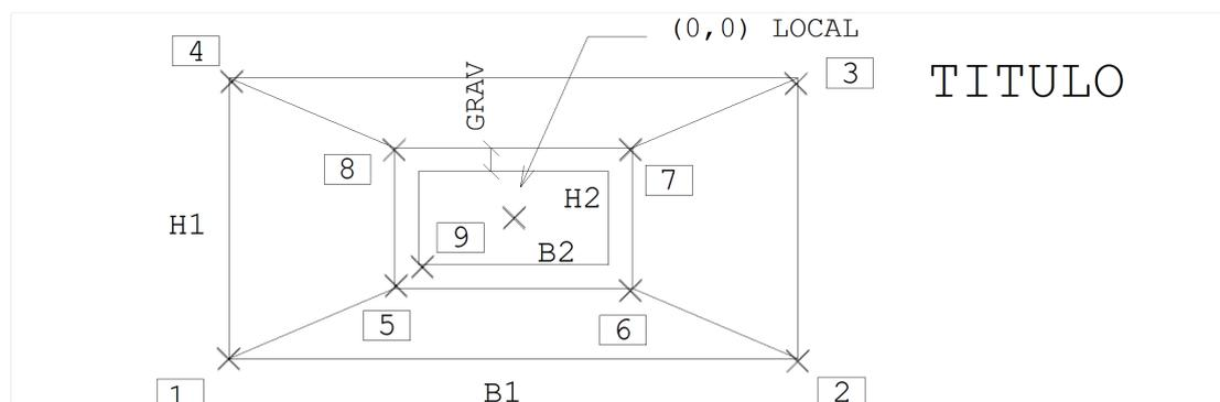
Os parâmetros que definem a sapata são: B1/H1, as dimensões externas, B2/H2 as dimensões do pilar sobre a sapata, e GRAV a largura da gravata. A sapata receberá também um título, colocado no lado direito superior. Adotaremos o default para a gravata e permitiremos a definição da escala como parâmetro; o subprograma SAPFOR.DPS será:
