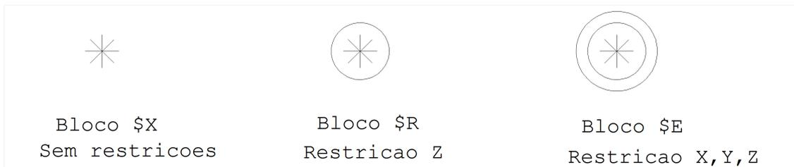
Uma vez que os nós são automaticamente definidos nas extremidades e intersecções de barras, normalmente o bloco que representa um nó sem restrições não é usado no desenho.
