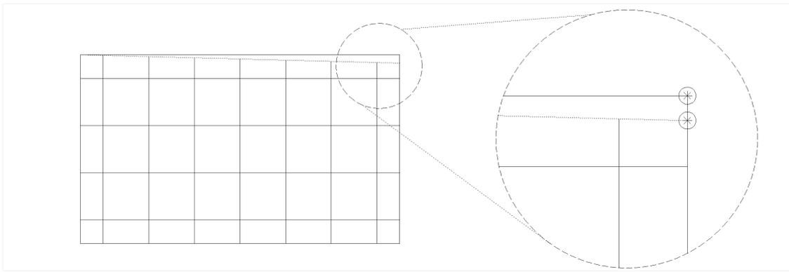
Devido a um erro no contorno, as barras não chegaram até o apoio, ficando em balanço. O mesmo tipo de erro pode acontecer para fora da laje:
