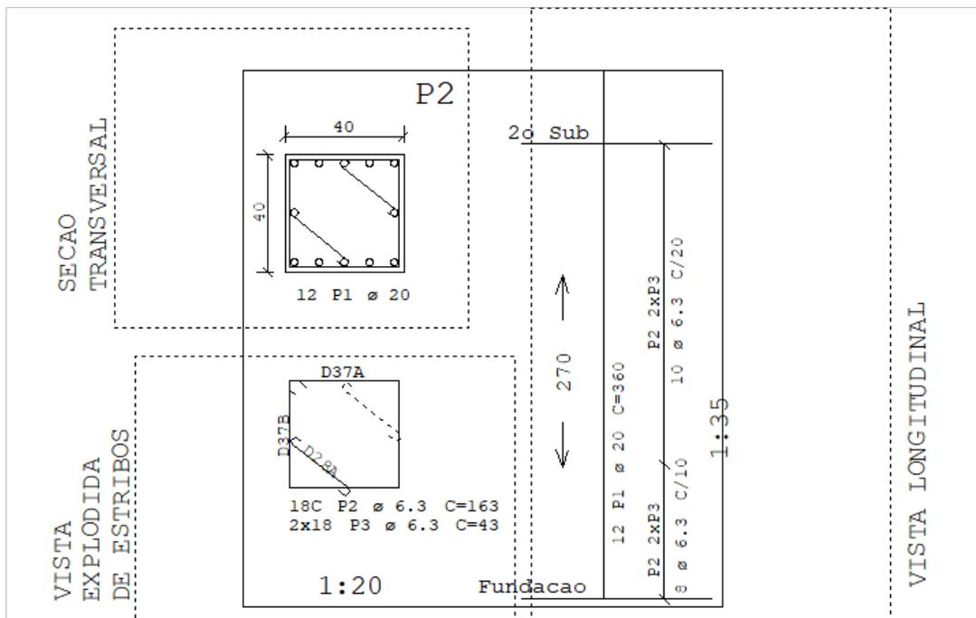
A seção transversal e a vista explodida de estribos são desenhadas em centímetros, na relação de 1:1 entre unidades do mundo real e de desenho. A escala de desenho da seção transversal é a escala principal do desenho, sendo lida e usada por todos os outros editores gráficos, editor de plantas e sistema de plotagem.
