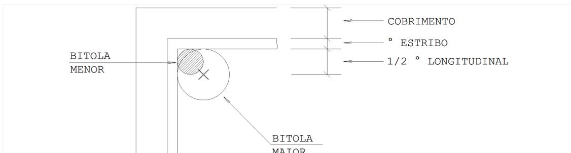
Em qualquer alteração de bitola, os ferros da primeira camada, serão reposicionados automaticamente, porém os da segunda camada, terão de ser movidos e reposicionados. Mais adiante mostraremos um comando genérico para projetar os ferros na face, a menos das distâncias mostradas acima.
