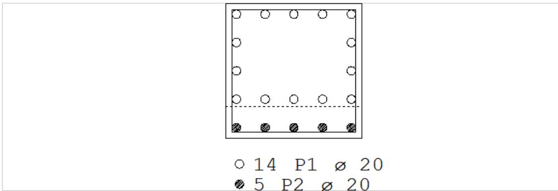
Na variação de seção do pilar, os ferros que tem traspasse foram representados de maneira diferente dos ferros que morrem no lance.
