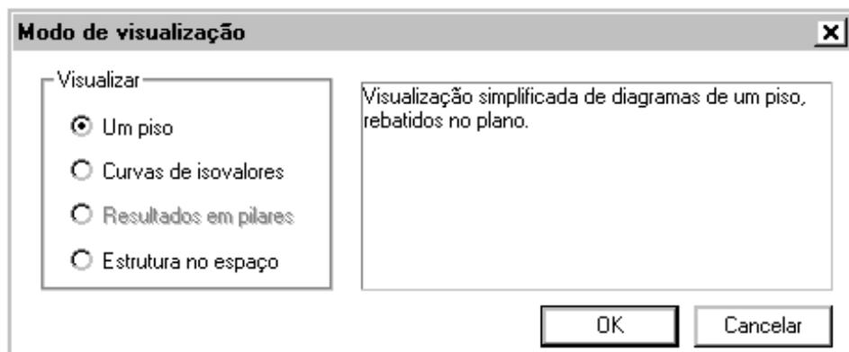
O primeiro modo (um piso) mostra o desenho de grelha em planta, o segundo modo (curvas de isovalores) mostra as curvas de isovalores e o terceiro modo (estrutura no espaço) mostra o desenho em perspectiva da grelha. Note que o modo “Resultado em pilares” está desabilitado e não é usado por este programa.
