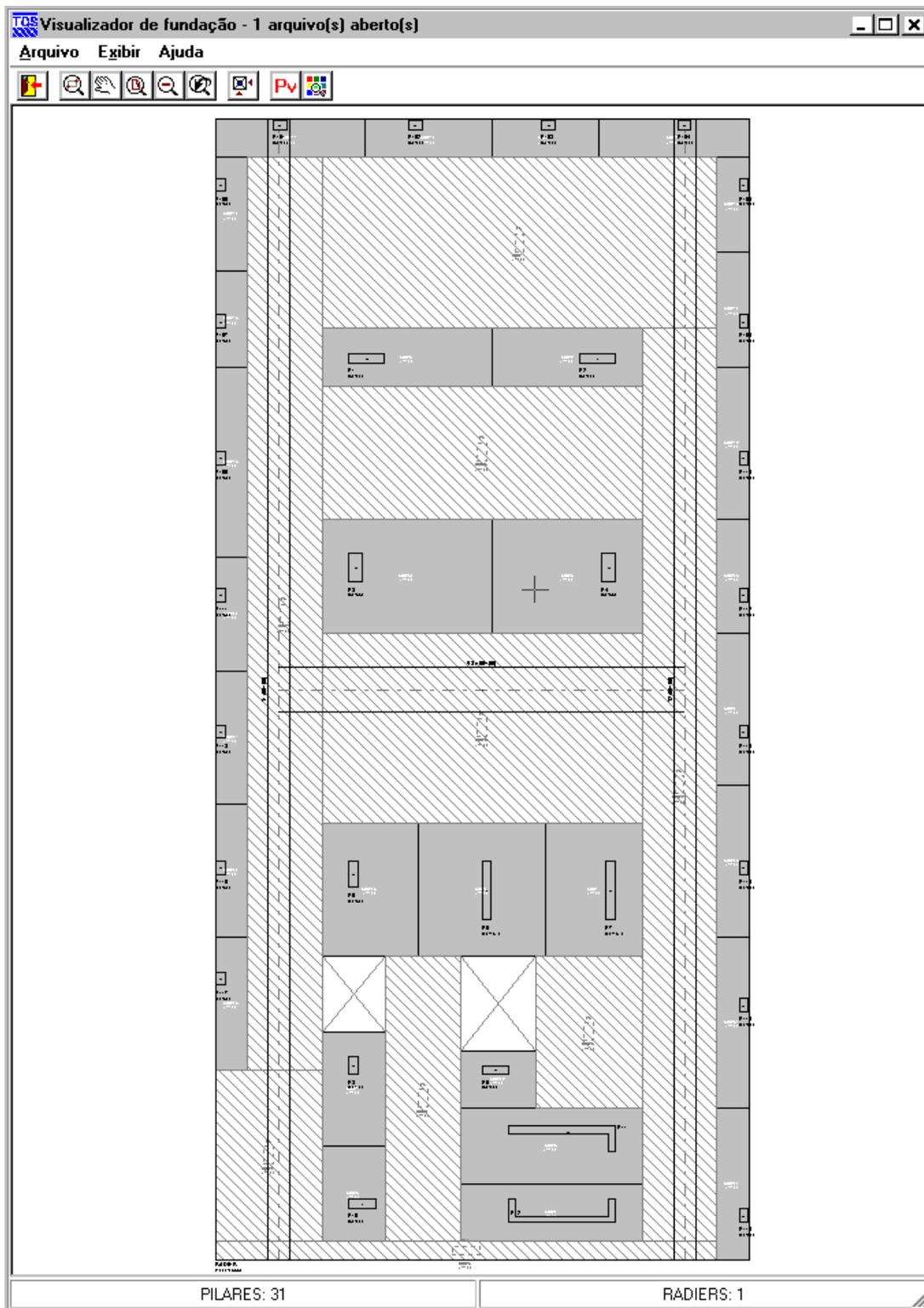
Esse edifício contém 31 pilares, 31 SCRs, 9 RCRs, 3 vigas de enrijecimento e 2 aberturas.
