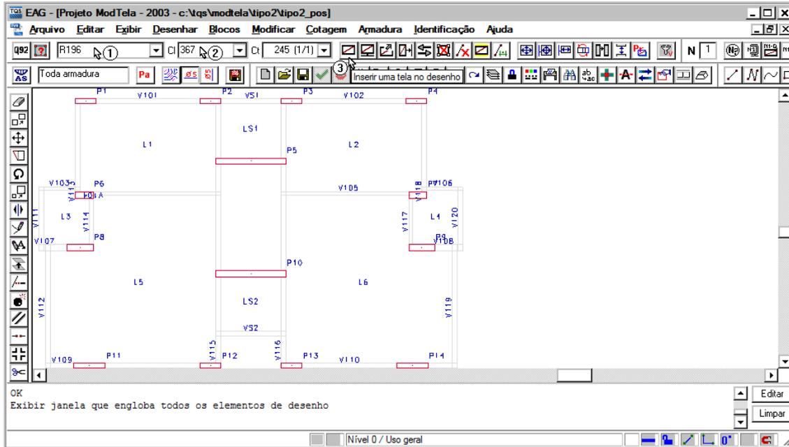
O comando de inserção de telas faz com que a tela fique “grudada” no cursor, esperando para ser inserida. Tecle “R” e defina o recobrimento de 3 cm, tecle “F4” para rodar a imagem da tela. Ela deverá estar nesta posição:
