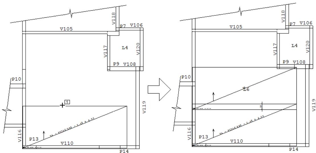
Configure o comprimento longitudinal "Cl" de 500 cm, use o comando "Inserir tela/referência".
