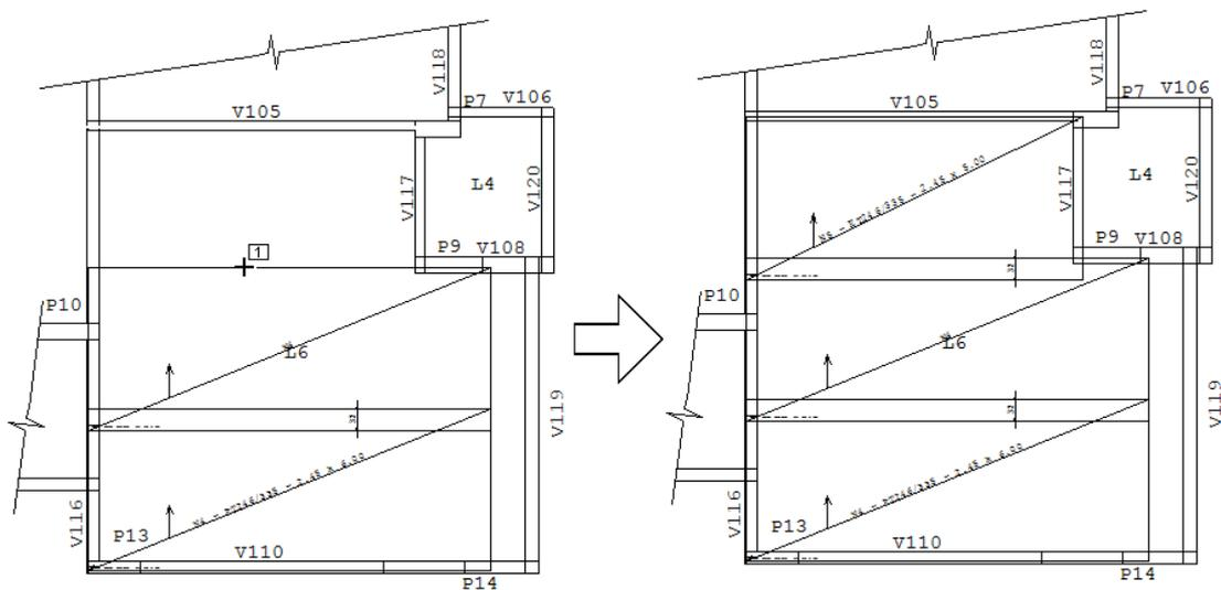
Configure o comprimento longitudinal "Cl" de 100 cm, use o comando "Inserir tela/referência".
