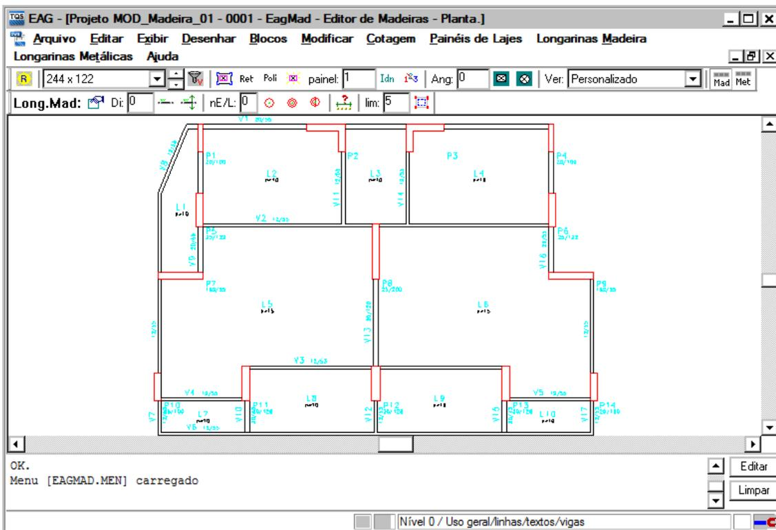
Este desenho contém a "máscara" para lançamento das chapas (painéis) nas lajes e os devidos escoramentos.
