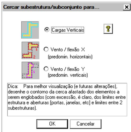
Escolha a cerca subestrutura para "Cargas Verticais", em seguida defina a poligonal conforme ilustração a seguir:
