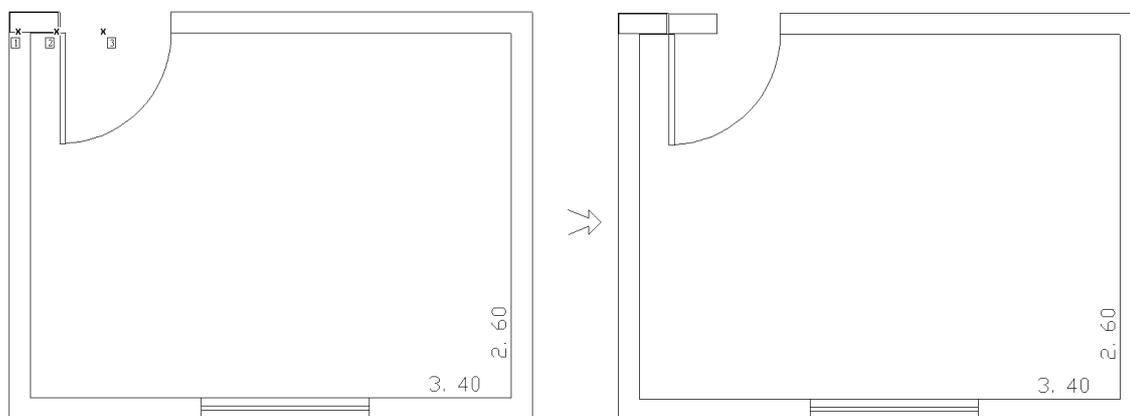
Após dar o comando de cópia, selecione o bloco a ser copiado, clique em um ponto de referência e em seguida no ponto de inserção.
