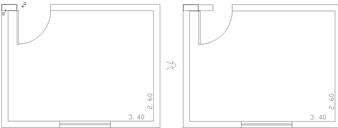
Clique no bloco de referência (ponto 1) e, após isso, clique na direção onde será inserido o bloco (ponto 2). Para inserir o restante dos blocos, basta clicar na direção da inserção.
