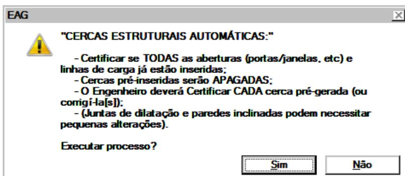
Ao se executar este comando (uma vez definidas todas as aberturas das paredes e suas linhas de carga e os critérios/parâmetros afins aferidos), o sistema determina, automaticamente, TODAS as cercas das subestruturas e
