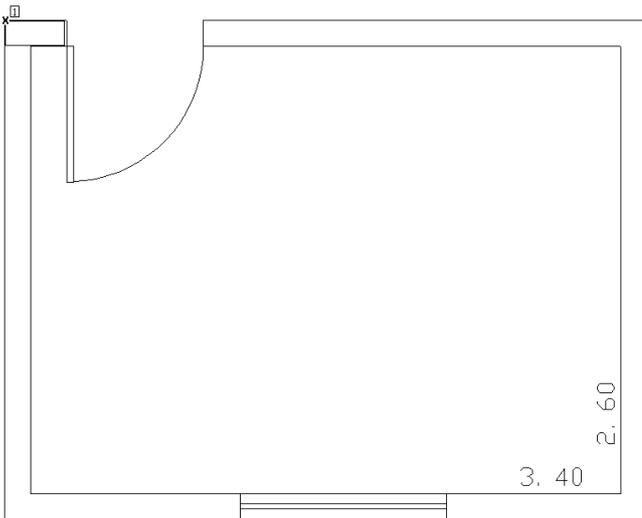
No exemplo acima, a espessura das paredes é de 15cm, portanto terá um revestimento de 0.5cm.
