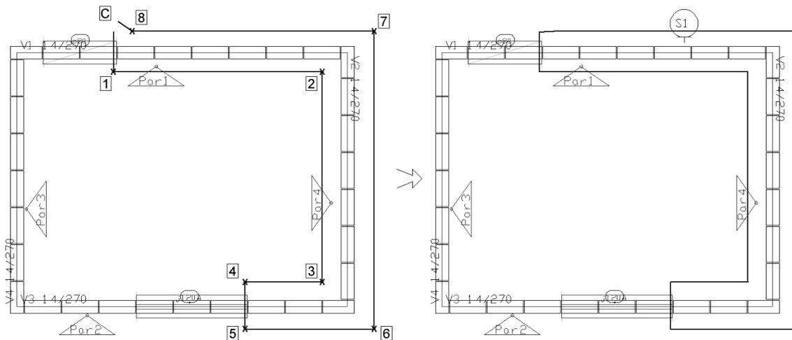
Clicar nos pontos indicados na figura, sendo o último apertando a tecla C para fechar a cerca, posicione o identificador da subestrutura, sendo que pelo menos uma parte do identificador deve estar dentro da cerca.
