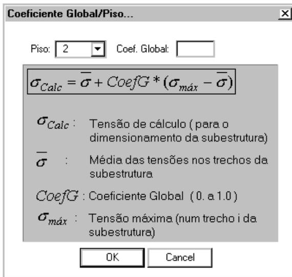
Após a definição do piso de incidência e do valor para o coeficiente global, posicione o texto com os dados dentro da poligonal que define a subestrutura.
