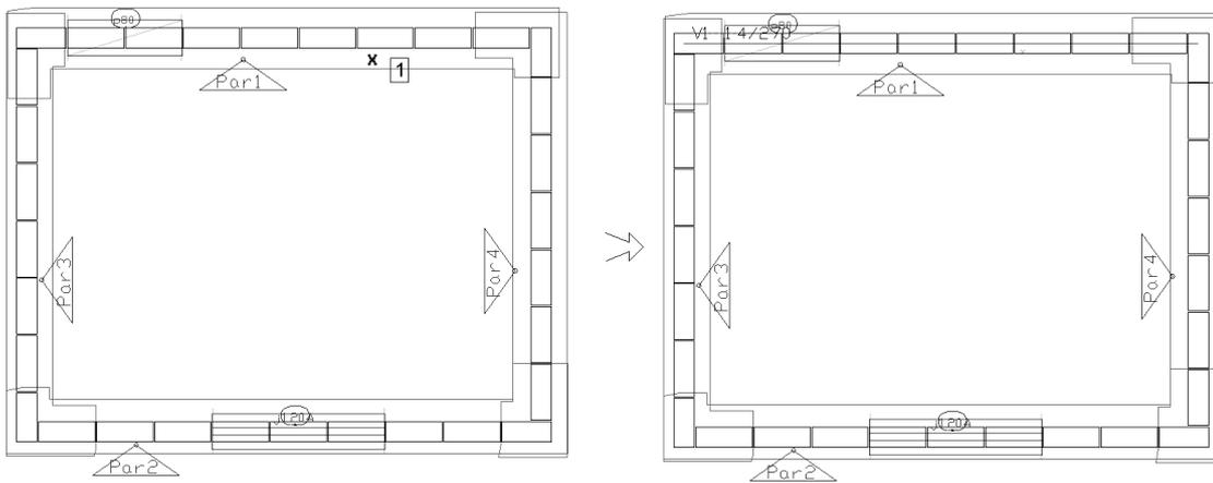
Note que os pontos inicial e o final da linha de carga estão definidos exatamente na projeção do alinhamento dos blocos que estão assentados na ortogonal, formado um ângulo de 90°. Note, também, que a linha de carga é posicionada sobre o eixo dos blocos da parede.
