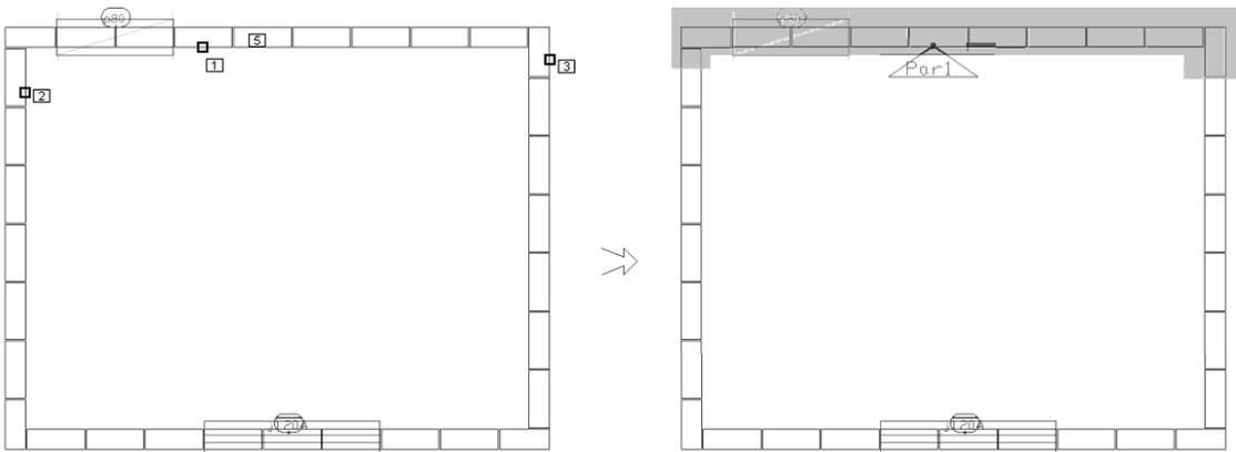
Clicar nos pontos indicados na figura, selecionando primeiro o bloco da própria parede e na sequência selecione a primeiro bloco de cada parede perpendicular adjacente, teclando <Enter> e então posicione o identificador da parede, sendo que pelo menos a ponta do triângulo deve estar dentro da cerca.
