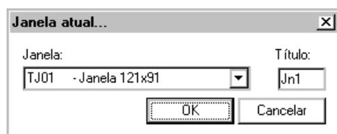
Em seguida, acione a sequência de comandos "Portas/Janelas" - "Inserir janela". Junto ao cursor, será arrastado o desenho da janela e o ângulo de inserção de uma janela obedecerá a definição do "Ângulo atual", definido no menu
