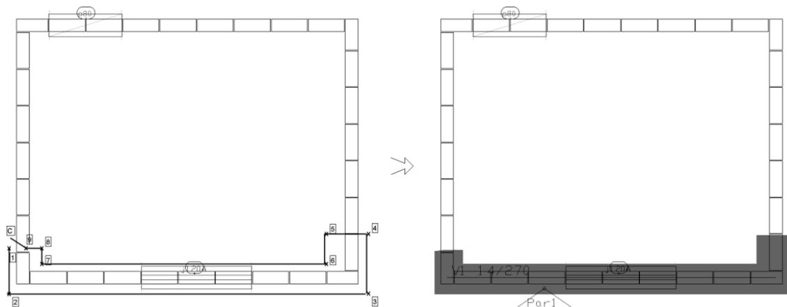
Clicar nos pontos indicados na figura, sendo o último comando apertar a tecla C para fechar a cerca. Posicione o identificador da parede, sendo que pelo menos a ponta do triângulo deve estar dentro da cerca.
