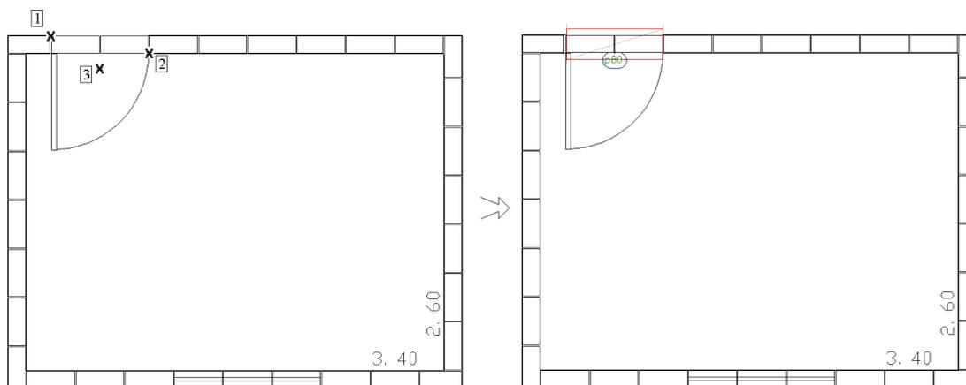
Após a seleção da porta, aperte a tecla 'm' para selecionar o ponto médio da abertura (ponto 1 e ponto 2), o ponto 3 é para posicionar a identificação da porta.
