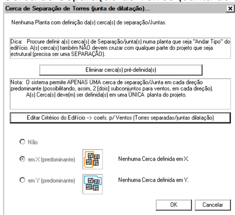
O conceito básico desta implementação é calcular as forças devidas à ação do vento para cada uma das estruturas independentes de alvenaria (separadas pela junta) e aplicar nestas forças coeficientes multiplicadores simulando os efeitos da pressão e sucção do vento, conforme coeficientes da ABNT NBR 6123:1988.
