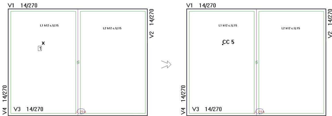
Após definir a carga e o caso de carregamento, clique no ponto onde será lançada a carga concentrada.
