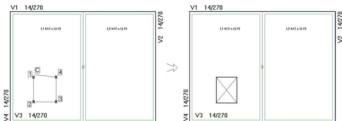
Acione o comando no menu "Lajes" - "Geometria" - "Furo/Shaft" e clique nos pontos fechando a poligonal do furo a ser feito na laje.
