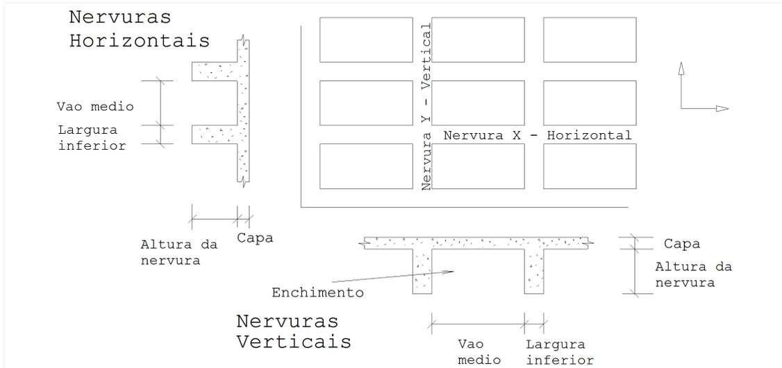
É preciso tomar cuidado para não trocar os dados das direções, em lajes com nervuras diferentes em X e Y. Veja, na figura, que os dados das nervuras horizontais são medidos na vertical, enquanto que os dados das nervuras verticais são medidos na horizontal.
