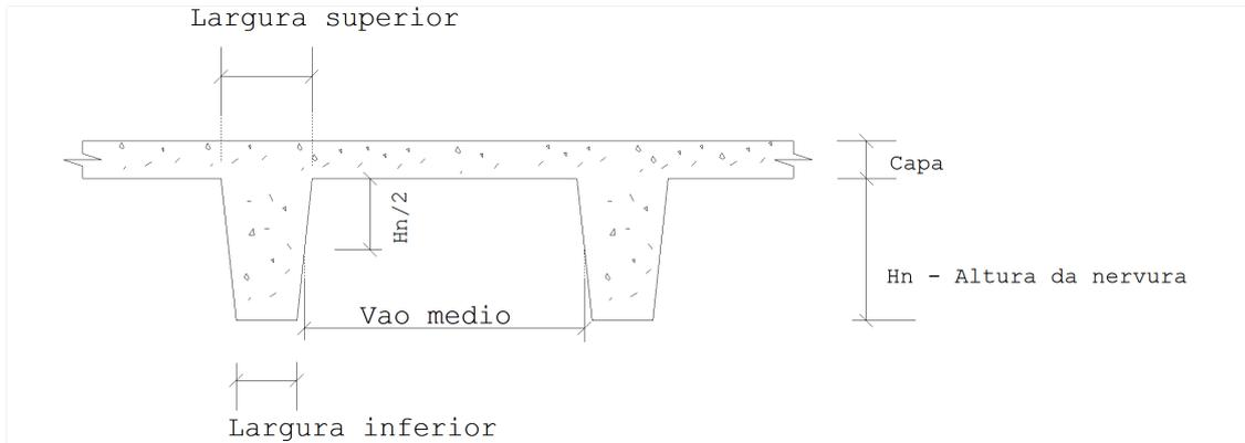
Para definir lajes nervuradas em apenas uma direção, defina zero nos dados da direção onde as nervuras não têm função estrutural:
