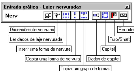
Criada a laje, os comandos para a definição de nervuras estão no submenu "Lajes" - "Nervuras". Existe, também, uma barra de ferramentas específica para este fim, que pode ser ativada através da barra geral.
