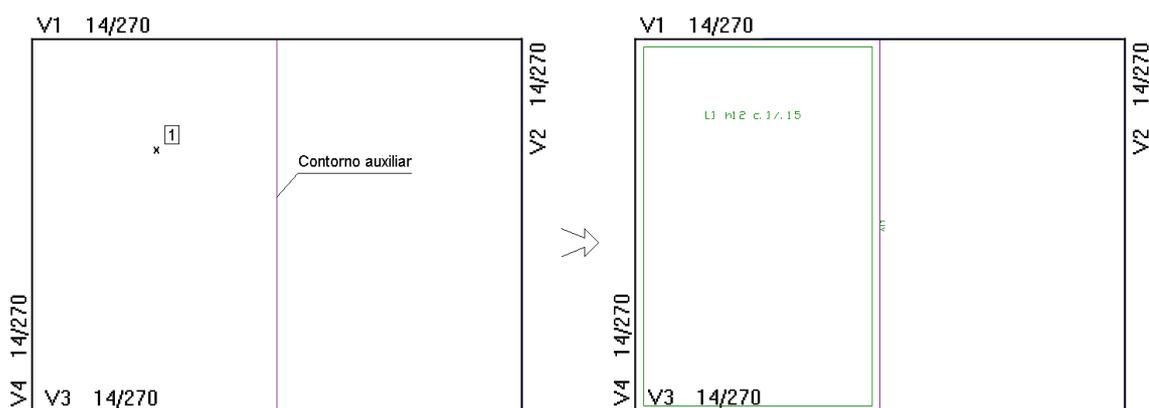
Clique em um ponto dentro do contorno onde se deseja inserir a laje. O programa fará a verificação deste contorno e depois pedirá um ponto para a inserção do texto da laje.
