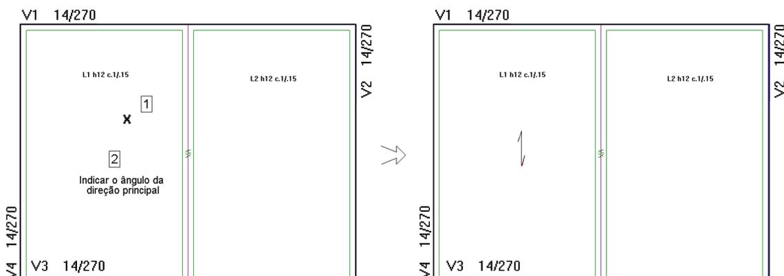
Clique na laje onde se deseja inserir o símbolo da direção principal e, em seguida, digite o ângulo dessa direção, a partir da horizontal.
