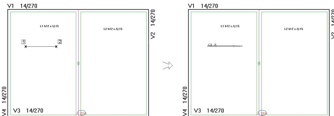
Após definir a carga e o caso de carregamento, clique nos pontos onde a carga distribuída será lançada.
