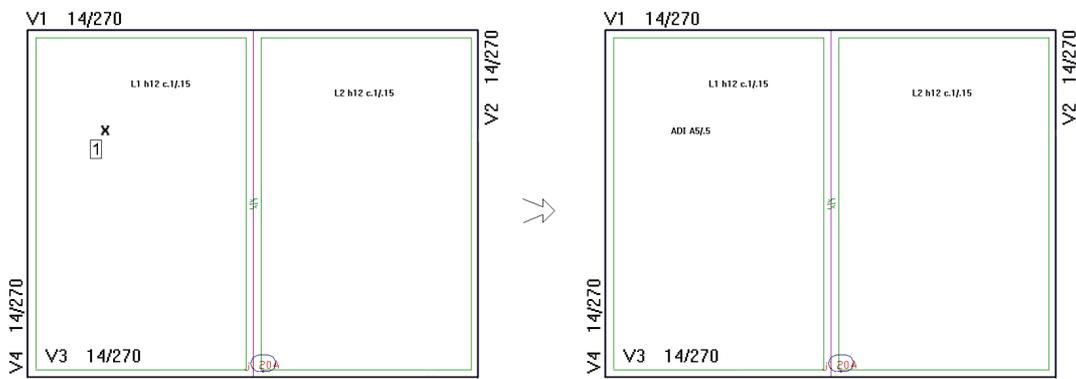
Após definir a carga e o caso de carregamento, clique na laje onde será adicionada a carga.
