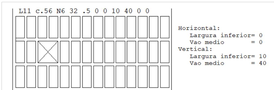
Na laje acima, as nervuras verticais tem 10 cm de largura e distância entre faces de 40 cm. As nervuras horizontais, com função apenas de travamento, são definidas com largura zero.
