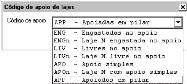
Você pode alterar o código de apoio na barra de ferramentas de lajes, ou através do comando "Laje" - "Dados" - "Parâmetros" ou do "Laje" - "Condições de contorno" - "Código de apoio da laje".
