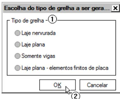
1. Selecione o tipo de laje utilizada no projeto (em geral "Laje plana" ou "Laje nervurada");
