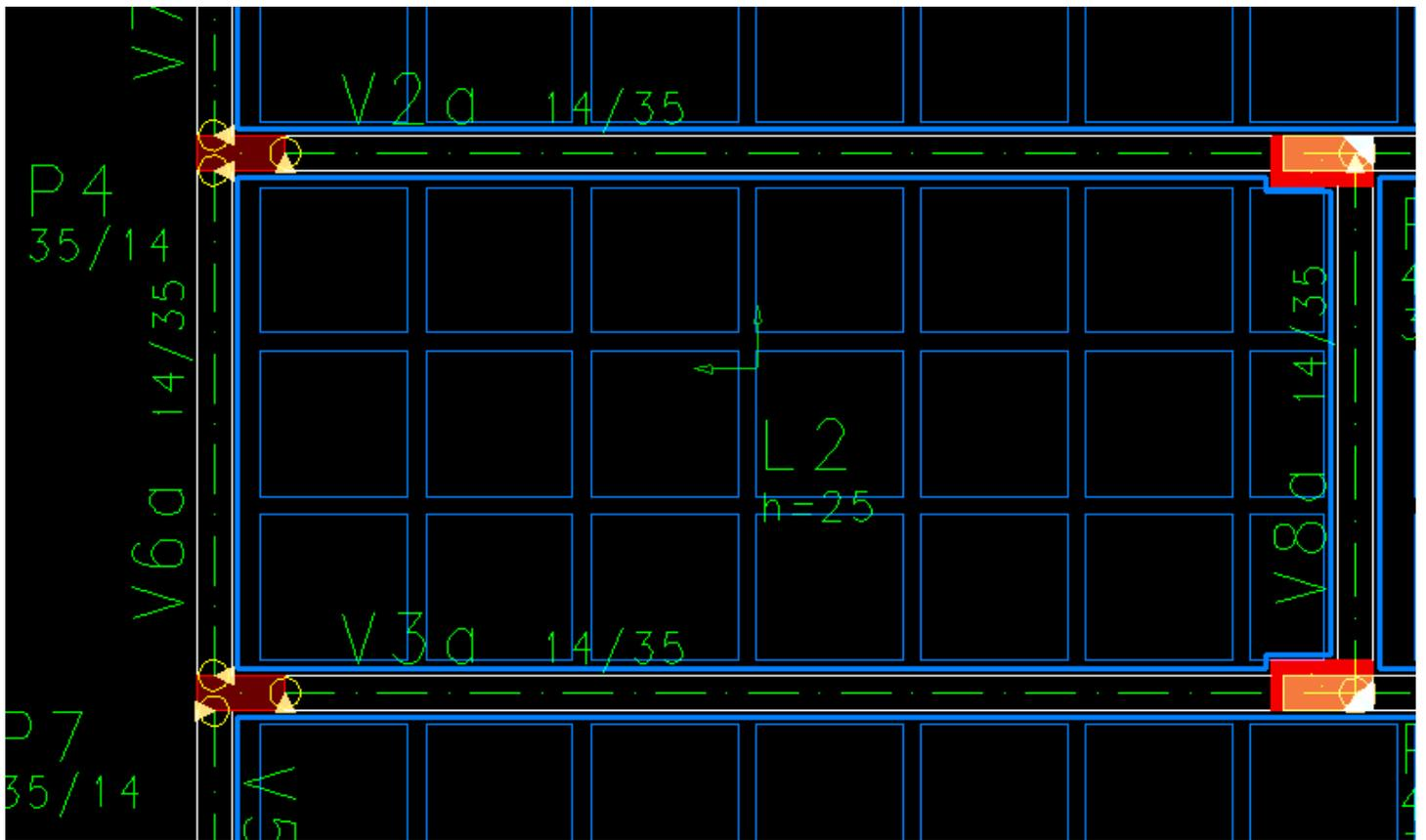
Se, no mesmo pavimento, existirem lajes treliçadas/nervuradas e lajes maciças, não é necessário lançar as formas de nervuras nas lajes maciças.
