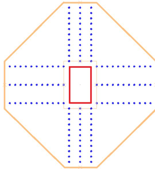
Caso contrário, serão distribuídas armaduras de punção partindo do primeiro perímetro a  $d/2$  do pilar, e avançando a menos de  $d/2$  do perímetro externo. A tensão resistente do concreto na presença de armadura de punção será calculada por:
