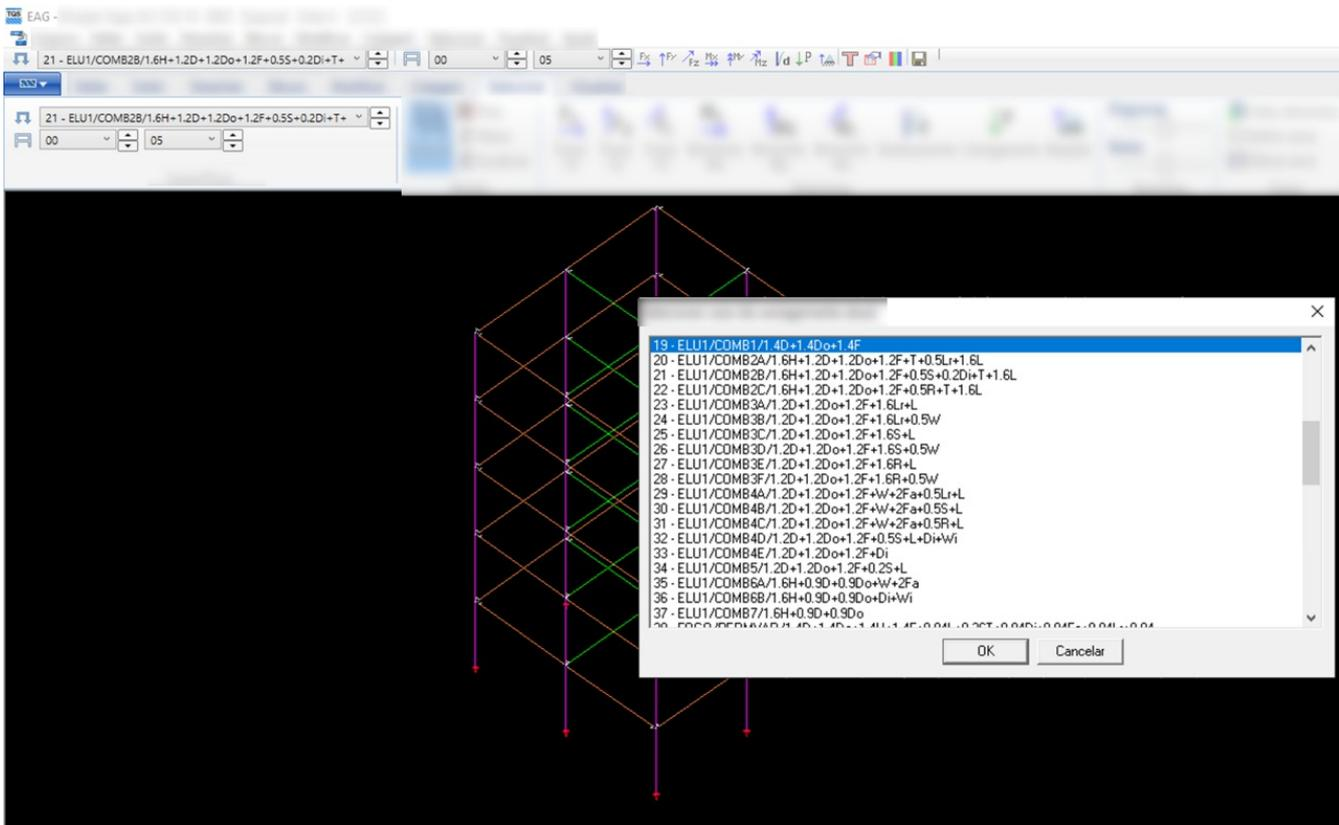
Foram introduzidas as combinações de serviços do item ASCE CC.2.1 no sistema, em que as combinações (D + L) e (D+ 0.5S) são utilizadas na verificação de flechas para efeitos de curta duração e a combinação (D+0.5L) se aplica na consideração dos efeitos de longa duração.
