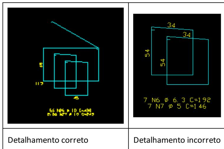
Além deste critério para o detalhamento de estribos visando a otimização do consumo de armaduras, o sistema de vigas possui um outro critério com esta mesma finalidade: <Cálculo da área total para estribos de 4 e 6 ramos>.
