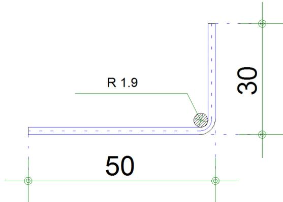
A convenção comum das máquinas de corte e dobra de aço é considerar os comprimentos medidos pelas faces externas. No exemplo acima, apesar dos comprimentos reais dos trechos serem diferentes de 50 e 30 cm (devido ao raio de curvatura), são estes valores que devem ser fornecidos para o corte e dobra.
