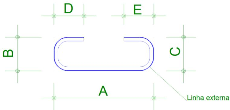
Ferros retos, estribos, estribos genéricos e grampos são representados por suas faces externas. Isto permite que ferros deste tipo sejam construídos no desenho paralelos às faces do concreto a menos do cobrimento. Neste caso, a alteração da bitola do ferro não torna sua geometria inválida.
